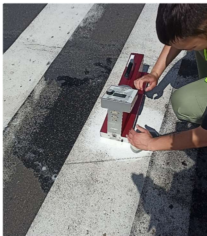
Рисунок 1 — Визначення коефіцієнтів яскравості ( \beta ) на очищеній дорожній розмітці
